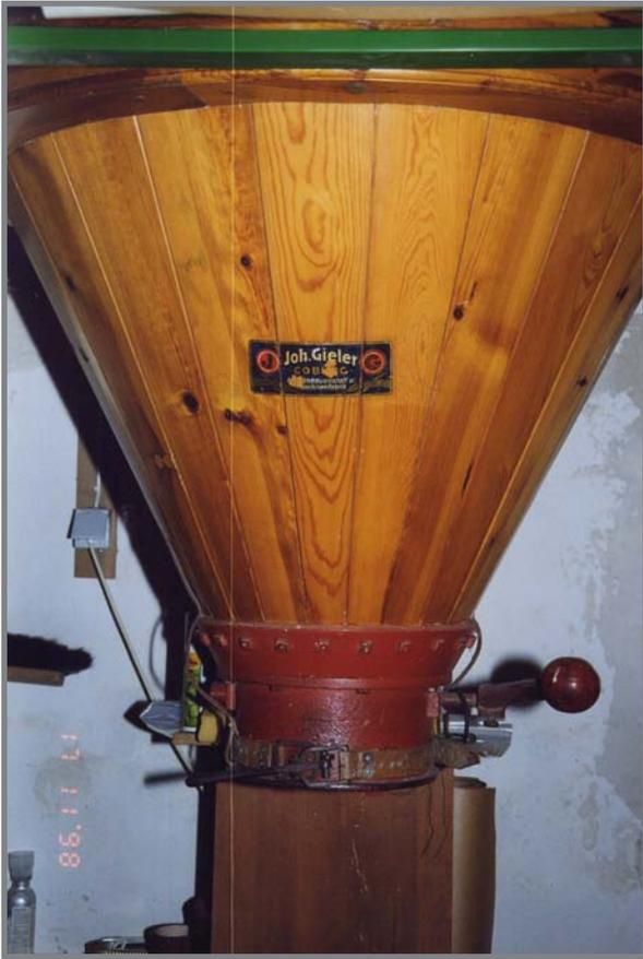
*In der stehenden Mehlmischmaschine - sie erstreckt sich über drei Stockwerke - sorgte ein Schneckengetriebe für die gewünschte Mischung.*
