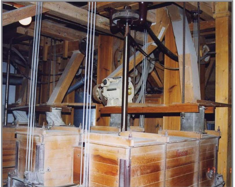
In den vier Plansichtern (Bilder oben) wurde das Mehl jeweils über 10 Siebe geführt. Im unteren Bild sind Aufhängung der Plansichtern (an Stahlseilen) und Antrieb gut zu sehen.
