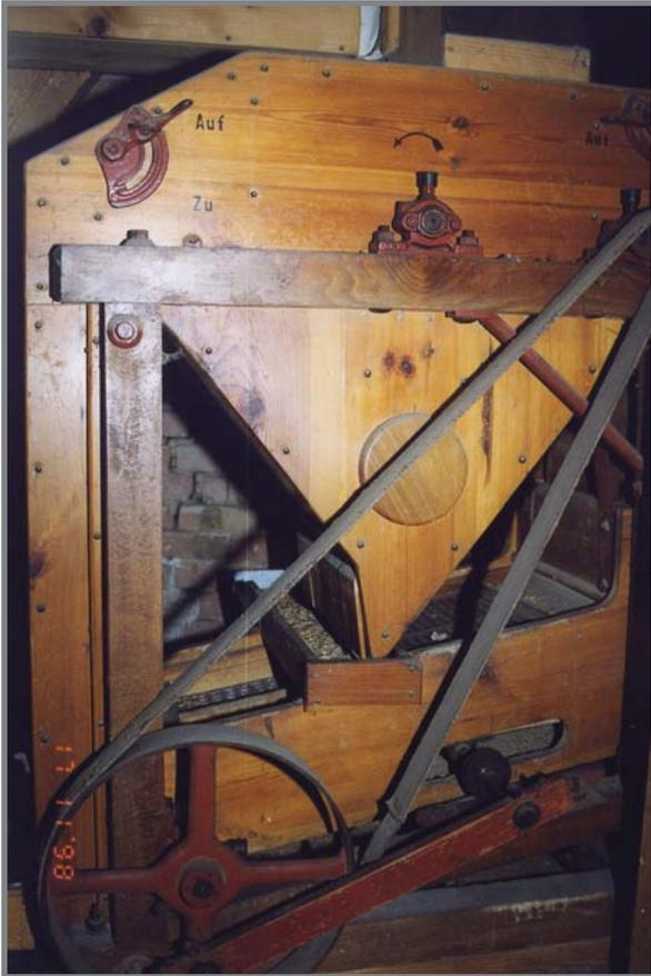
In der Putzmaschine wurde das Getreide von Staub und Unkrautsamen gereinigt.
